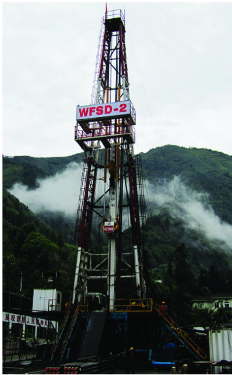
图1 KZ3000型科钻深部取心钻机
