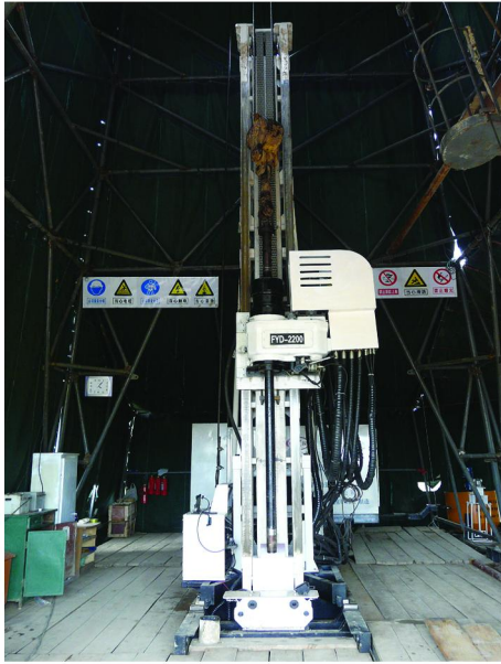
图4 FYD-2200型钻机在安徽周集铁矿施工现场
