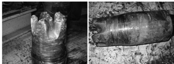
图4 DP19井水平段PDC钻头磨损情况
