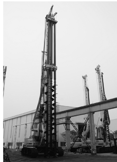
图4 SM85型伸缩钻杆式多轴深层搅拌钻机的现场安装
