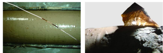
图1 浸泡试验土样表面形成的塑胶状薄膜
