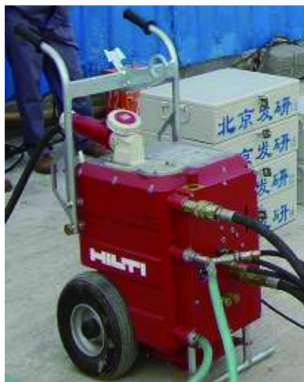
图2 D-LP32 型液压动力系统
