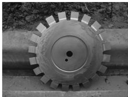
图2 Ø350 mm 整体式锯片(R=6 mm)
