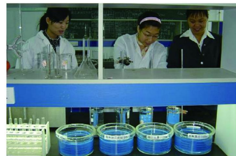
图5 PVC在不同水质中腐蚀结垢试验
