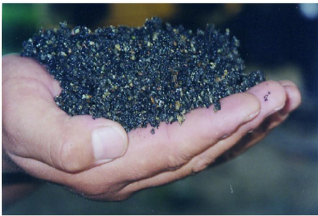
图2 井底排出的黑色腐蚀产物
