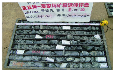
图2 ZK1703号钻孔破碎带岩心照片
