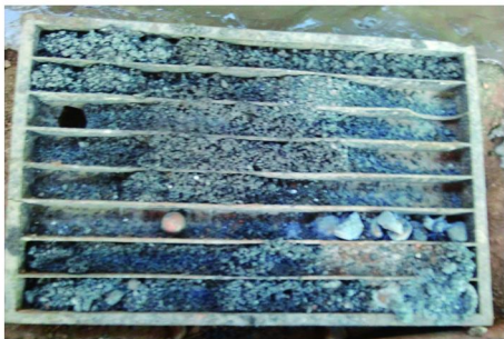
图3 ZK1903号钻孔捞砂器捞起的钻渣照片
