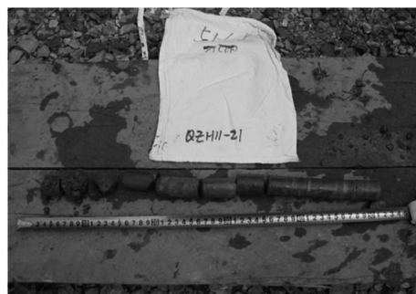
图7 采用S46绳索取心钻具取出的岩样
