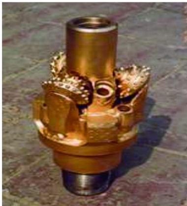
图2 KZ157/311型扩孔钻头(带前导钻头)
