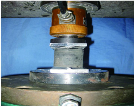
图2 抗拉强度实验
