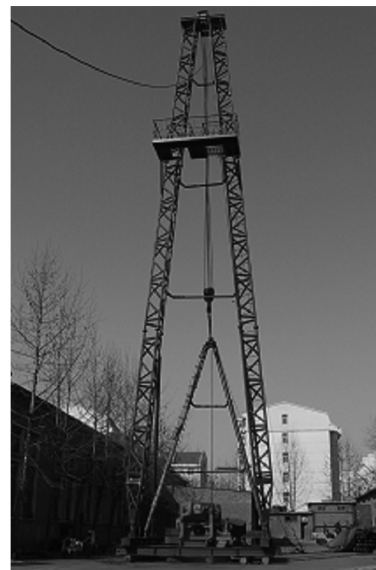
图 1 XB-2000 型岩心钻机配 A 型桁架结构塔
