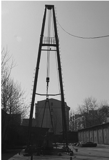
图2 ST-1000型岩心钻机(或XY-4型)配A型管塔
