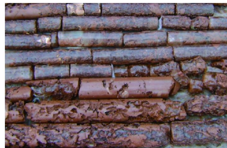
图1 取出的高矿化度泥岩岩心
