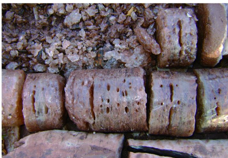
图3 泥岩与岩盐不整合接触面在沉积过程中形成的“蜂窝”状连通小溶洞
