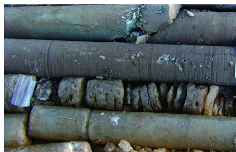
图2 取出的泥岩和石盐层接触面段的岩心
