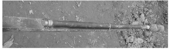
图2 现场加工连接好准备下井的导斜楔
