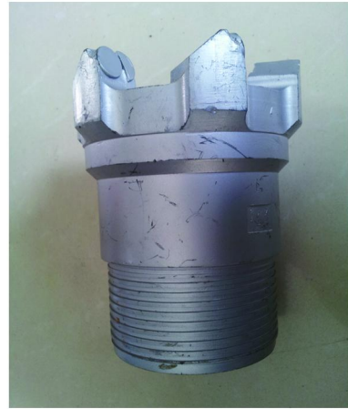
图2 \varnothing 113 mm 复合片肋骨取心钻头
