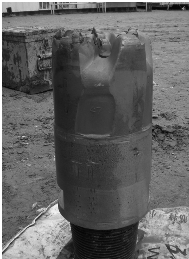
图1 PDC钻头磨损至本体尺寸
