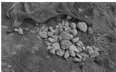
图3 钻机反循环泵排出的完整卵石
