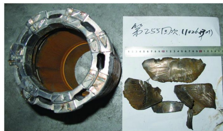
图8 处理事故后遗留的钻具残骸和被破坏的PDC钻头
