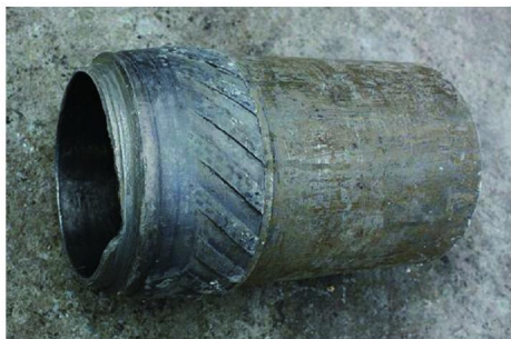
图6 折断的SDB钻具上扩孔器
