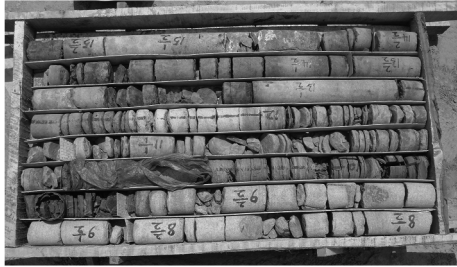
图2 绳索取心钻进取出的岩心
