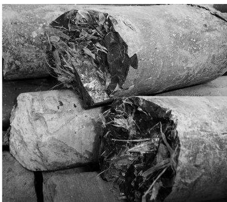
图1 漳平东山崎矿区 ZK7001 孔 258~267 m 孔段堵漏水泥心 (问题:纤维材料过于粗大,混合不均)
