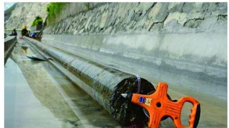
图 1 取出的心样(长度 19.28 m,直径 197 mm)
