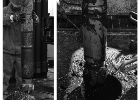
图 4 扭力冲击器入井和出井照片
