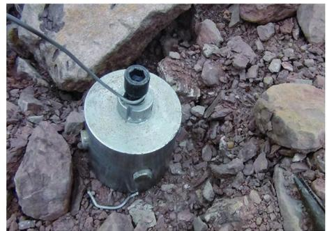
图 3 四爪型堵孔器
