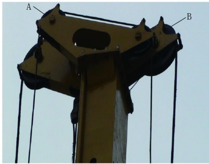
图 5 卸土时和天轮频繁磨损的钢丝绳部分
