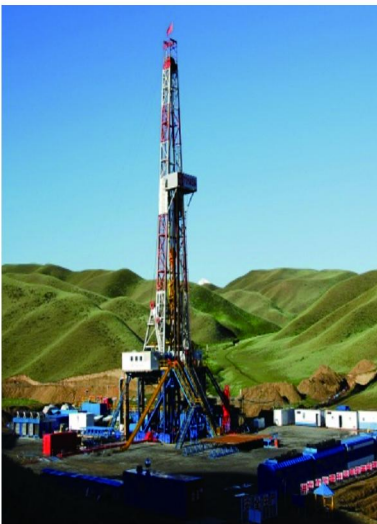
图 2 地热钻探选用的石油钻机
