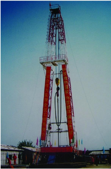
图 1 地热钻探选用的地质钻机
