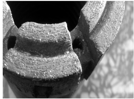
图 2 低温烧结对金刚石热损伤小
