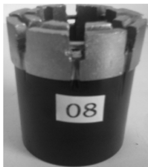
(b) 架桥式钻头
