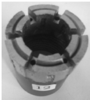
(a) 底喷双层水口钻头
