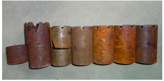
图6 断裂损坏的卡簧座
