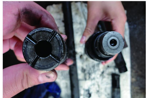
图 3 下活塞与锤轴接头的敲击磨损
