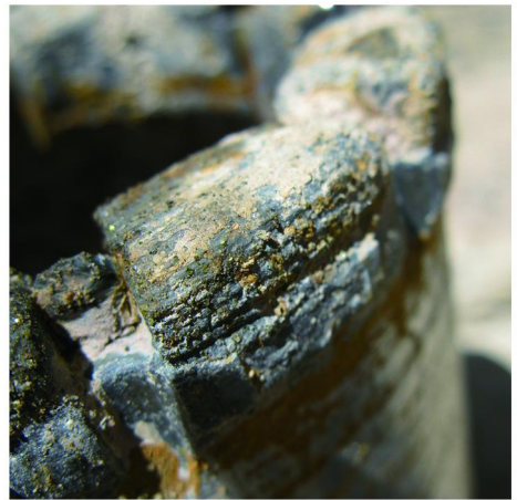
图10 水口宽4 mm钻头效果图
