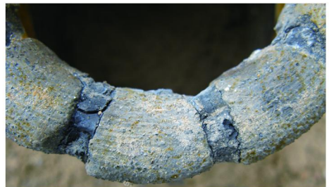
图11 水口宽4 mm钻头效果图
