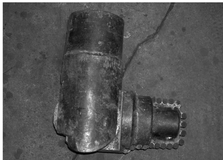
图 3 损坏单翼局部扩孔钻头
