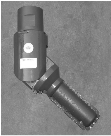
图 2 局部扩径单翼扩孔钻头
