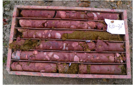
图1 苏州大阳山隧道上部岩心样
