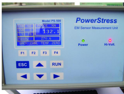
图 3 PS-500 磁弹仪检测锚固段钢绞线应力分布
