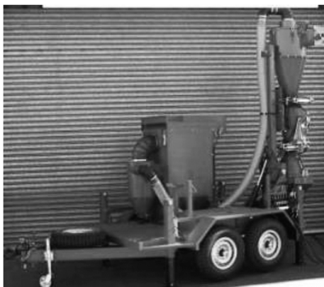
图16 可旋转的圆锥缩样器拖车取样系统
