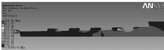
图 8 钻杆管体外螺纹等效应力云图 II
