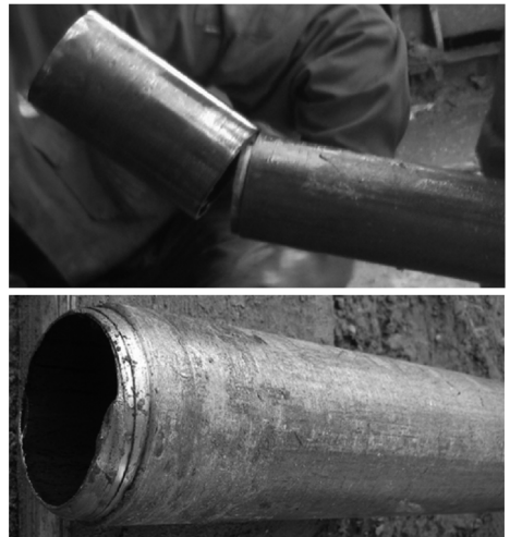
图 9 现场钻杆管体发生破坏情形
