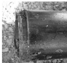
图 1 发生断裂的钻杆管体
