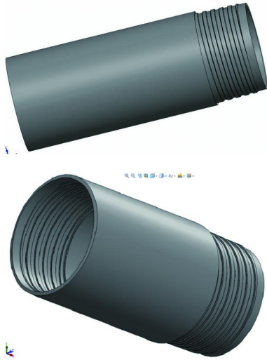
图3 钻杆管体、接头三维实体模型
