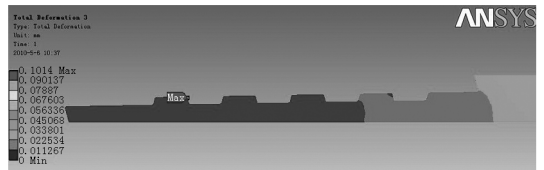
图 10 钻杆管体外螺纹总变形云图
