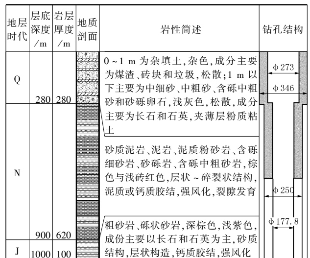
图 1 地质设计的钻孔结构图
