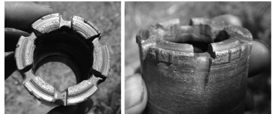
图7 石英砂层对钻头的磨损情况
