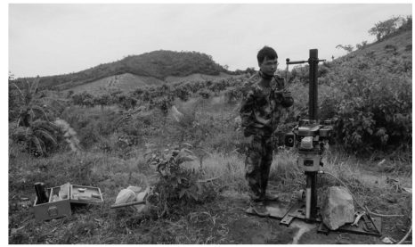
图 2 TGQ-15 型轻便浅层取样钻机在海南某矿区施工全貌
