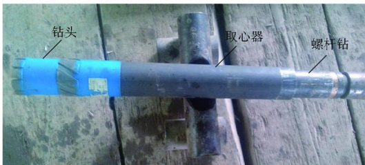
图 4 定制的双管单动取心器(安装于钻头和螺杆之间)
