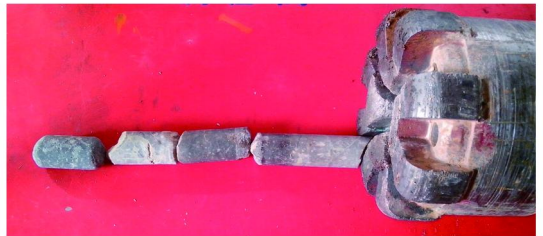
图 5 金刚石钻头中心水眼取心
