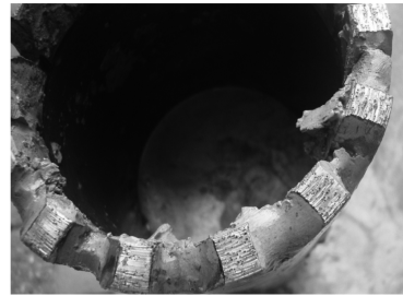
图8 2号钻头钻进第一回次的出刃情况
