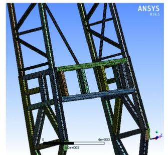
图2 塔架局部网格划分图
