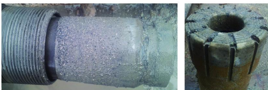
图 5 岩屑倒吸现象
