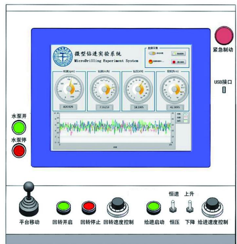
图2 主机操作控制台
