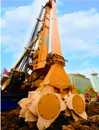
图 1 Bauer BC40 型 CSM 设备
