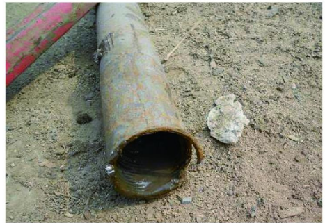
图 9 钻进过程中被折断的绳索取心钻杆
