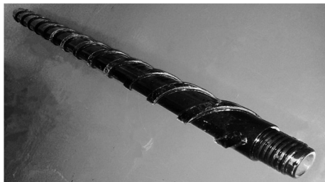
图1 \varnothing 89/73 mm 大通孔宽叶片螺旋钻杆
