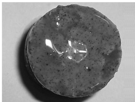
图3 受复合型泥浆浸泡土样
