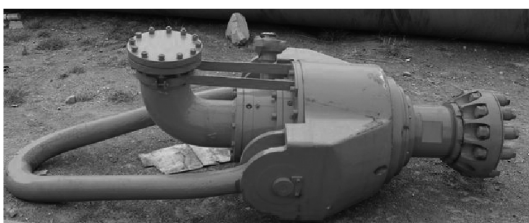
图5 气举反循环送水器
