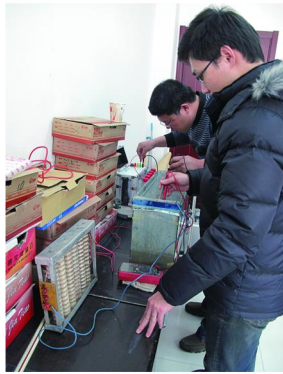
图 9 泥浆电阻率实验室内测量
