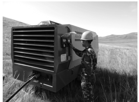
图4 阿特拉斯 XAVS500 型空压机
