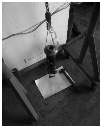
图 7 取样后装置密封性渗漏测试
