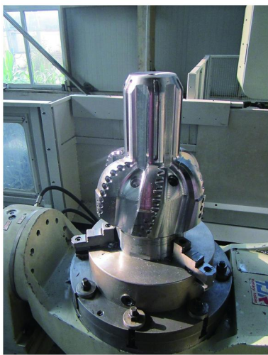
图 19 钻头钢体数控加工过程
