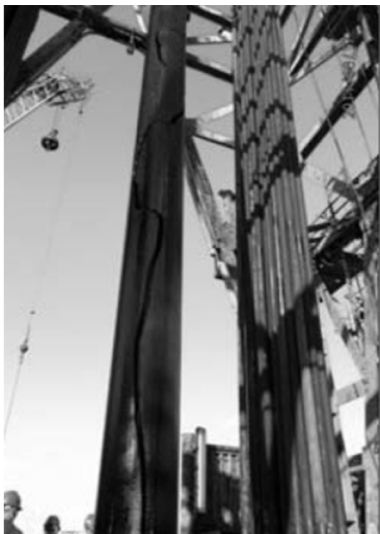
图 4 成螺旋状破裂的套管
